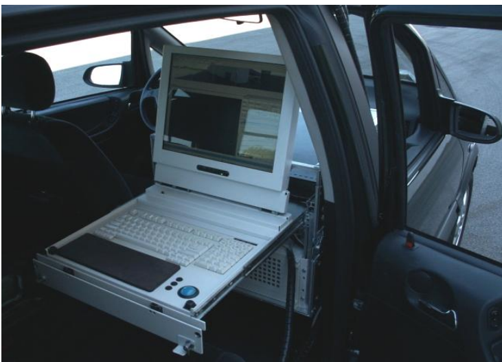
Figura 2 : Workstation di acquisizione e controllo
